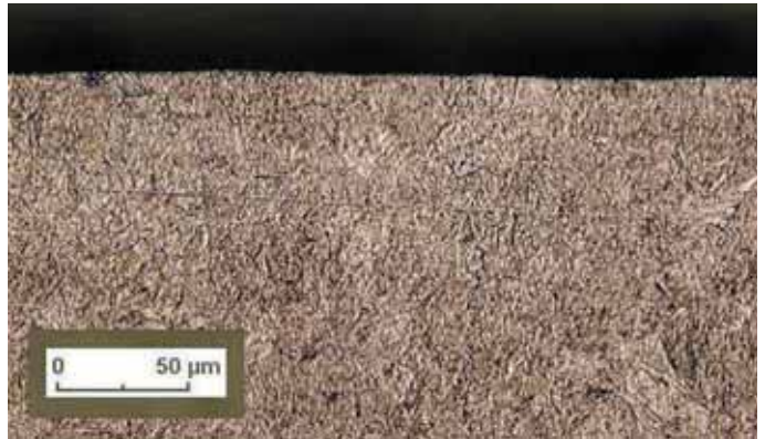
Oberflächenbeschaffenheit nach Fräsen mit Hartmetall-Werkzeug Surface finish following milling with carbide tool
